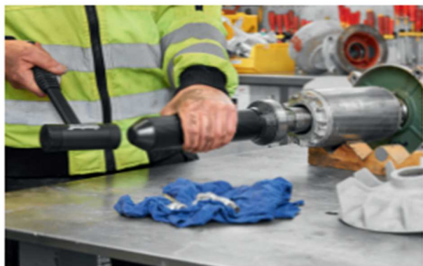
FT33 đảm bảo lực lắp phân bố đều trên toàn bộ vòng trong và ngoài của ổ trục và không tạo ứng lực lên các phần tử lăn
