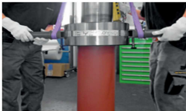
Dụng cụ mang vòng bi BHT cho phép nâng an toàn và định vị chính xác cho vòng bi của trục turbine.
