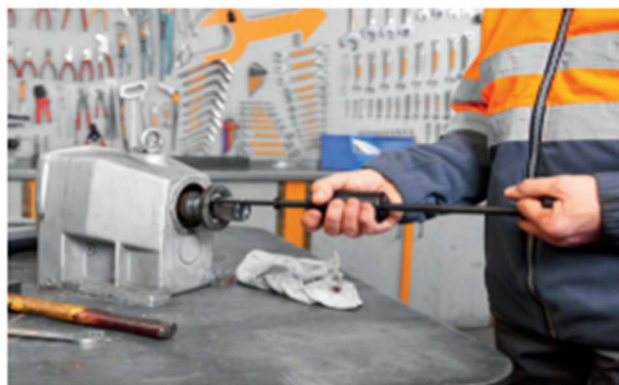
Sử dụng SP50 để tháo phốt của hộp số mà không làm hư hại đến ổ hay trục
